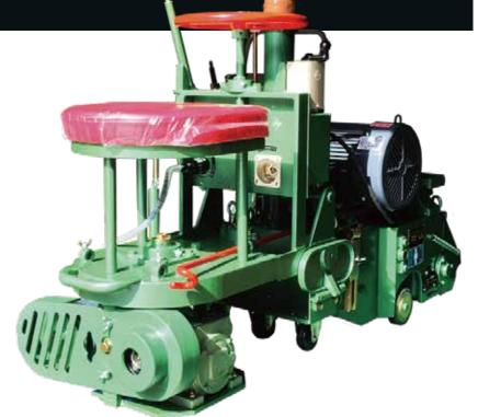
305型フロアーサンダー兼用機は、大規模な現場から狭い現場までを1台でカバーする用途の広いフロアーサンダーです。 広い現場では走行機ユニットをジョイントし、オートサンダーのように乗りながら作業することができます。そして、狭い現場では走行機ユニットを分離しての手引き作業と、ユーザーのニーズに幅広く対応します。
